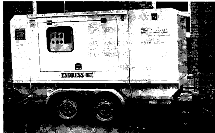
Bild 1: (mit zugehöriger Betriebserlaubnis): Netzersatzanlage
